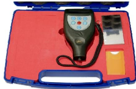
Apparecchio elettronico per la misurazione dello spessore della vernice su carrozzerie in alluminio o acciaio.
