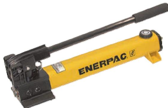
Leggera e compatta, serbatoio in nylon e corpo rivestito in nylon per una maggior resistenza alla corrosione. Risparmio di tempo grazie alle due velocità negli avvicinamenti del pistone, prima di arrivare al contatto in pressione. Serbatoio grande per una maggior versatilità di azione. Valvola di sicurezza incorporata. Raccomandata per l'uso con pistoni da 10 e 20t.
